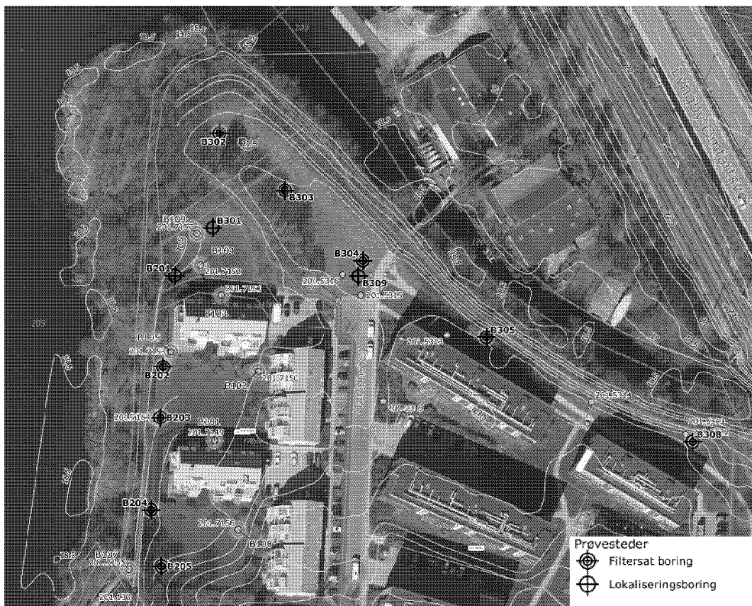
Figur 4.1: Kort med placering af de udførte prøvetagningspunkter, B303-305 og B308 samt borerne B201-B202 på Mortonsvej 8-42. Findes også i bilag 1.
